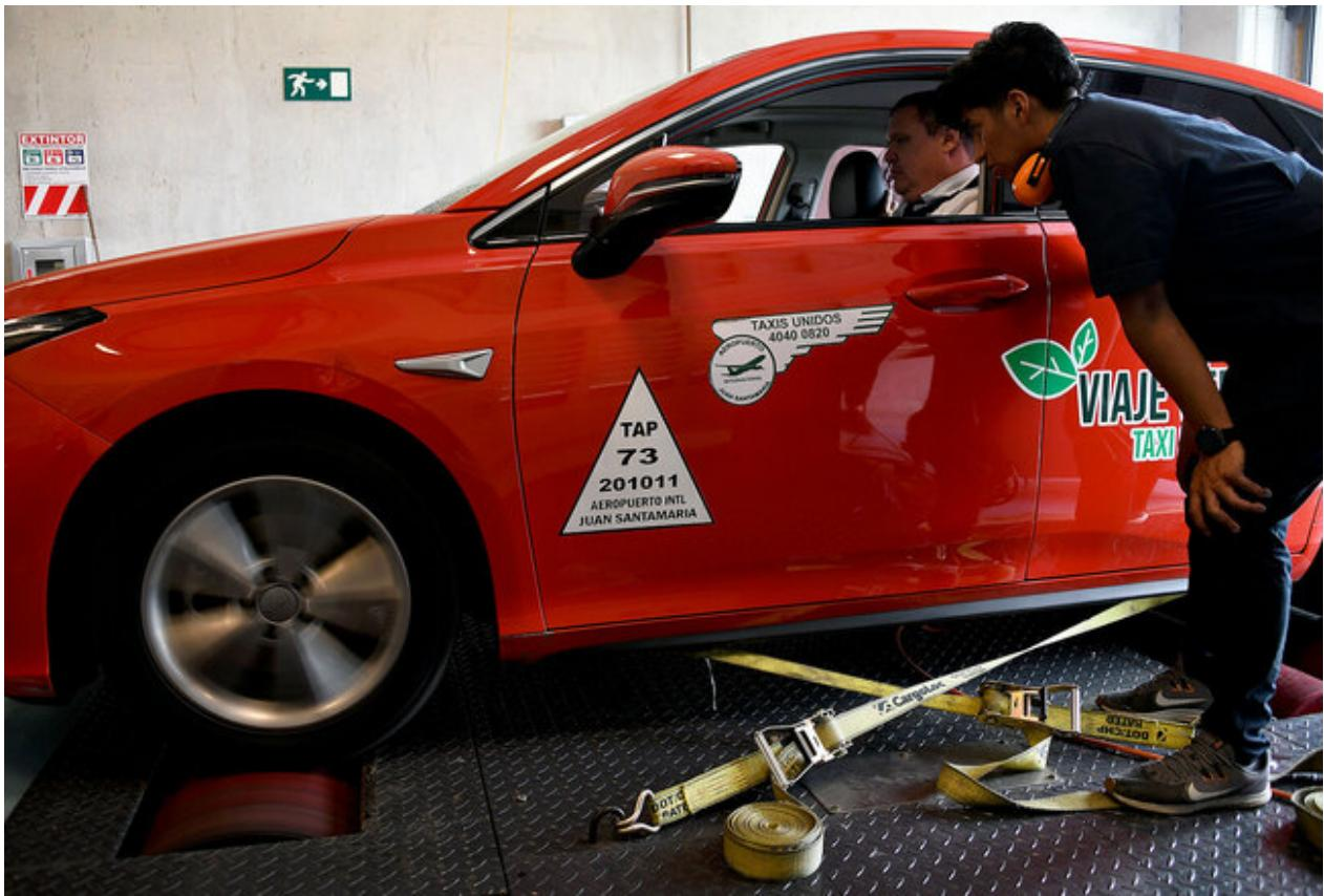
Los estudios de potencia, consumo de combustible y emisión de gases de de vehículos con motor de combustión interna o eléctrico se realizan en el dinamómetro de chasis de la Escuela de Ingeniería Mecánica (EIM) de la Universidad de Costa Rica.
