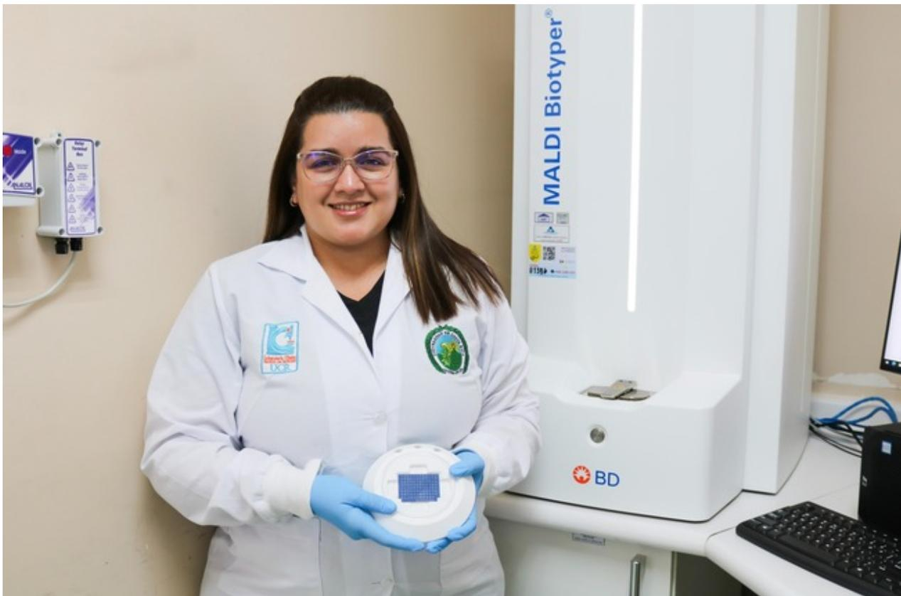
Al introducir la muestra, la máquina crea un espectro de masas —un gráfico de intensidad— que es específico para cada especie patógena. Posteriormente, el espectro obtenido para un determinado microorganismo se compara automáticamente con la base de datos
