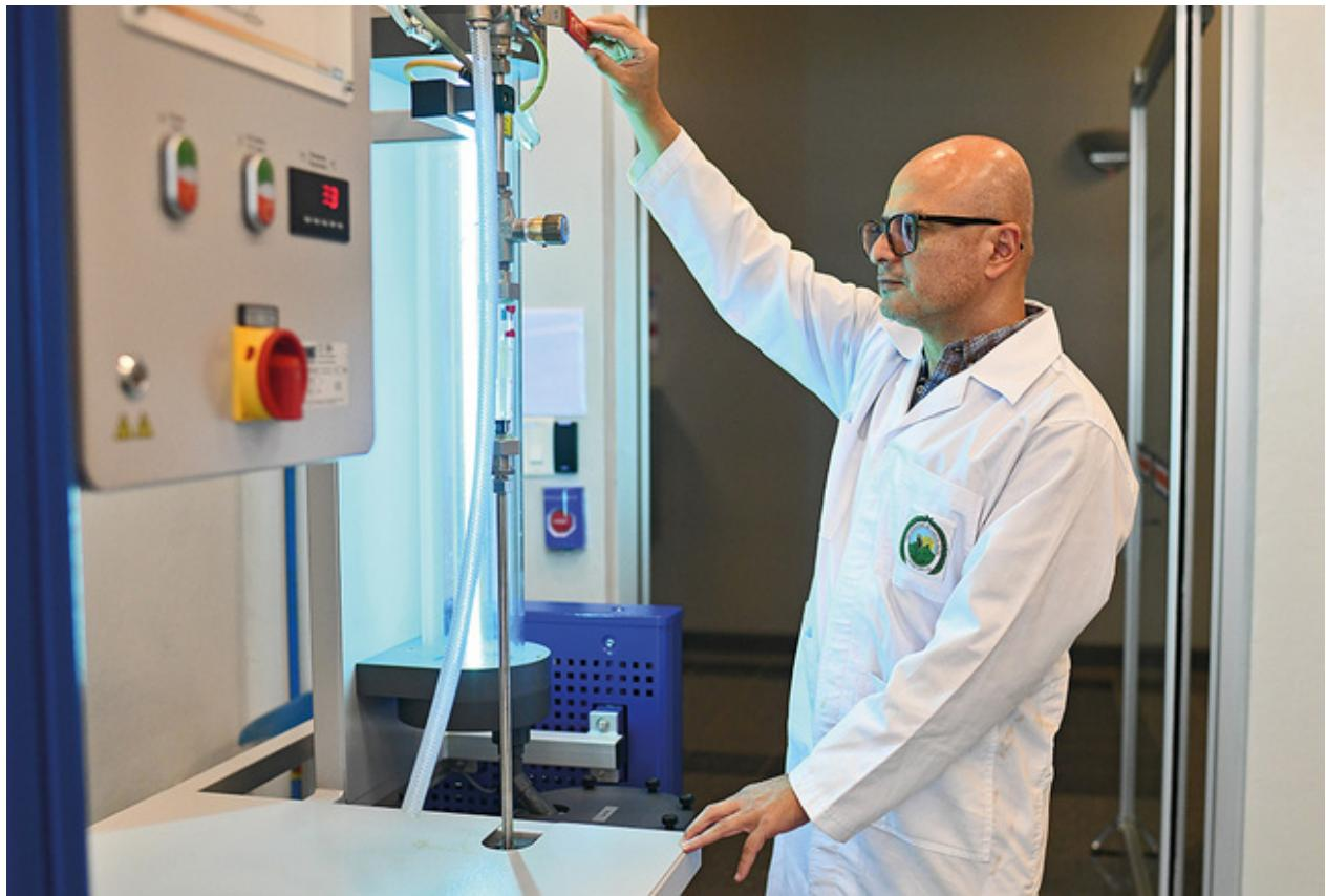
Los investigadores utilizan un reactor ultravioleta de película descendente, que sirve para probar el tratamiento de agua mediante procesos de oxidación avanzada a escala de laboratorio. Foto: Laura Rodríguez.
