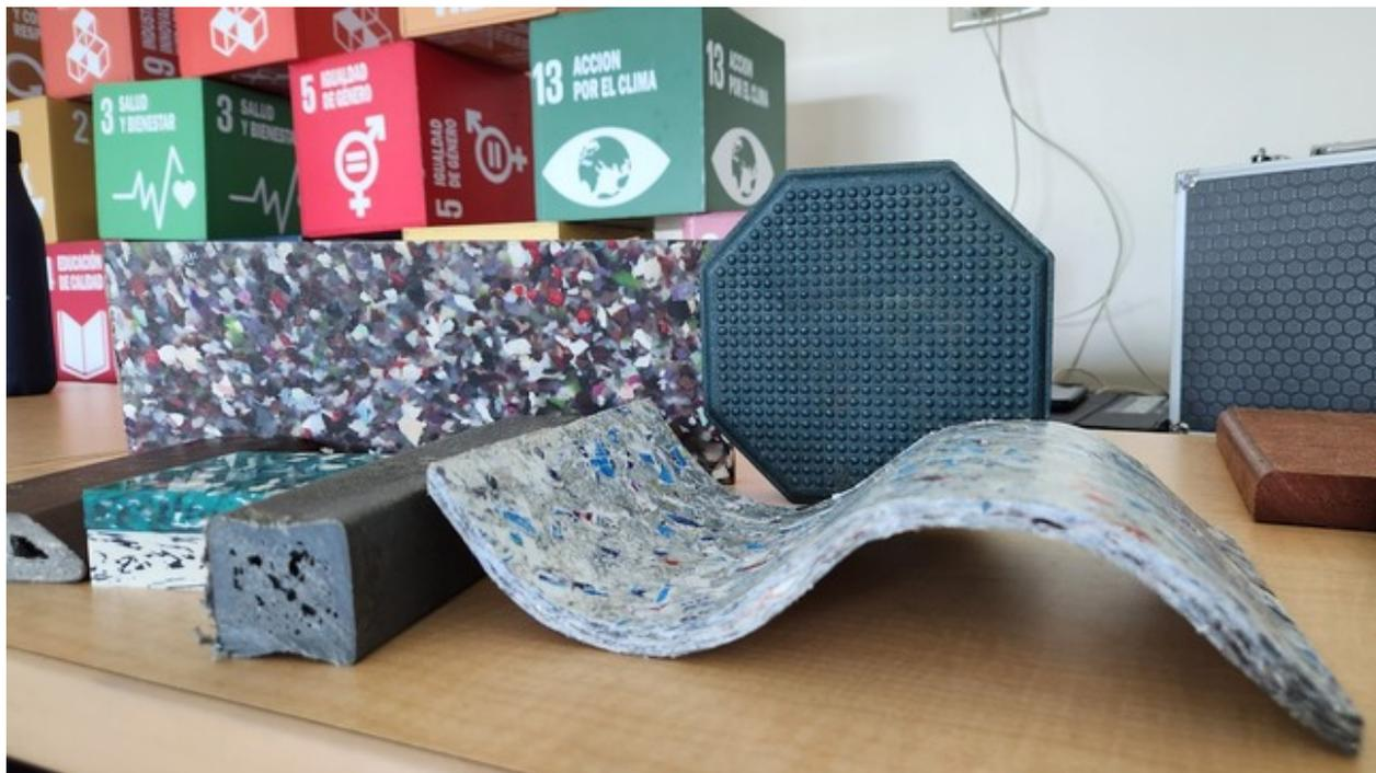
El plástico reciclado puede ser utilizado en la fabricación de ladrillos, tejas o maderas plásticas, entre otros materiales que tienen muchas aplicaciones.
