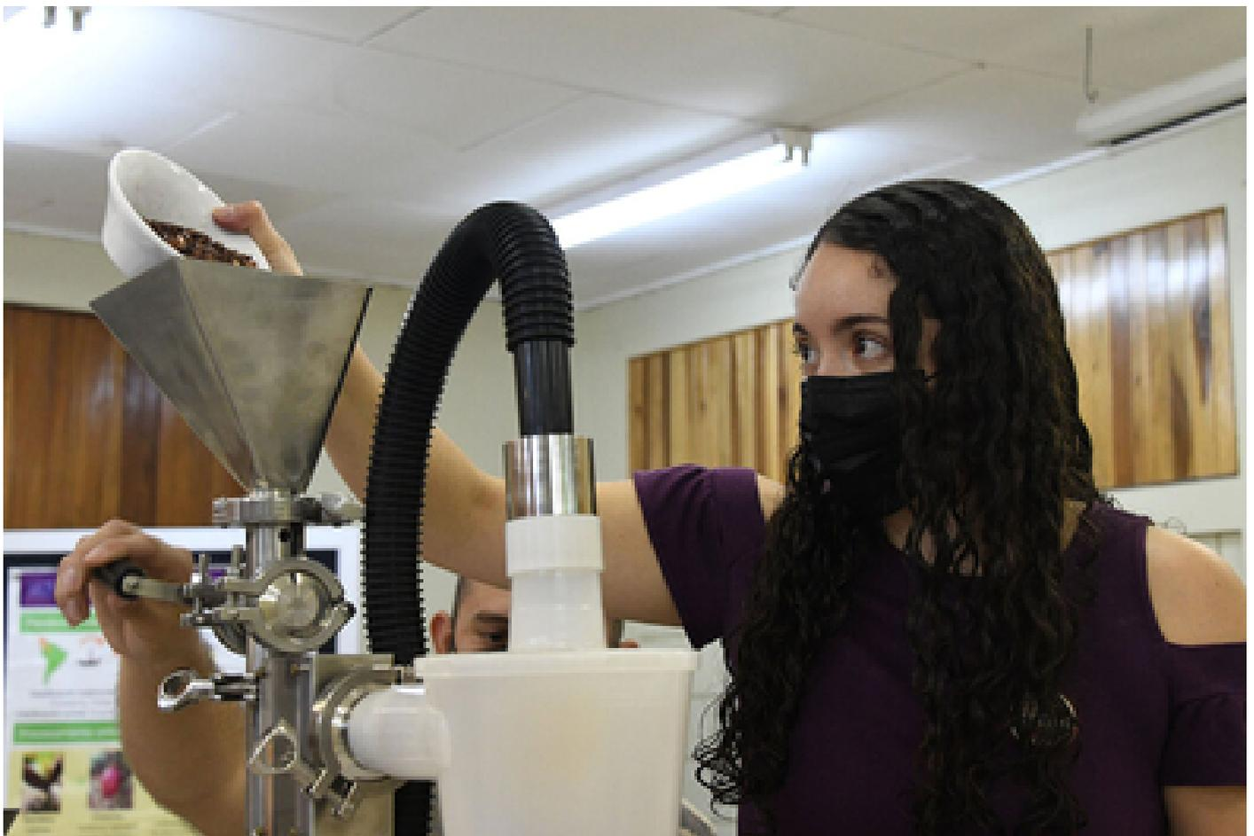
El descascarillado es la separación de la cascarilla de los nibs por diferencia de densidad al hacer pasar una corriente de aire con una máquina de descascarillar o de forma manual.
