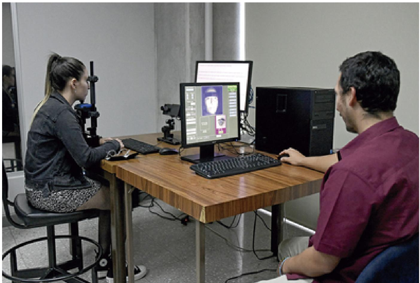
El estudio del movimiento de los ojos se efectúa para obtener información de nuestros procesos cognitivos. Esto se realiza mediante un dispositivo de rastreo ocular.
