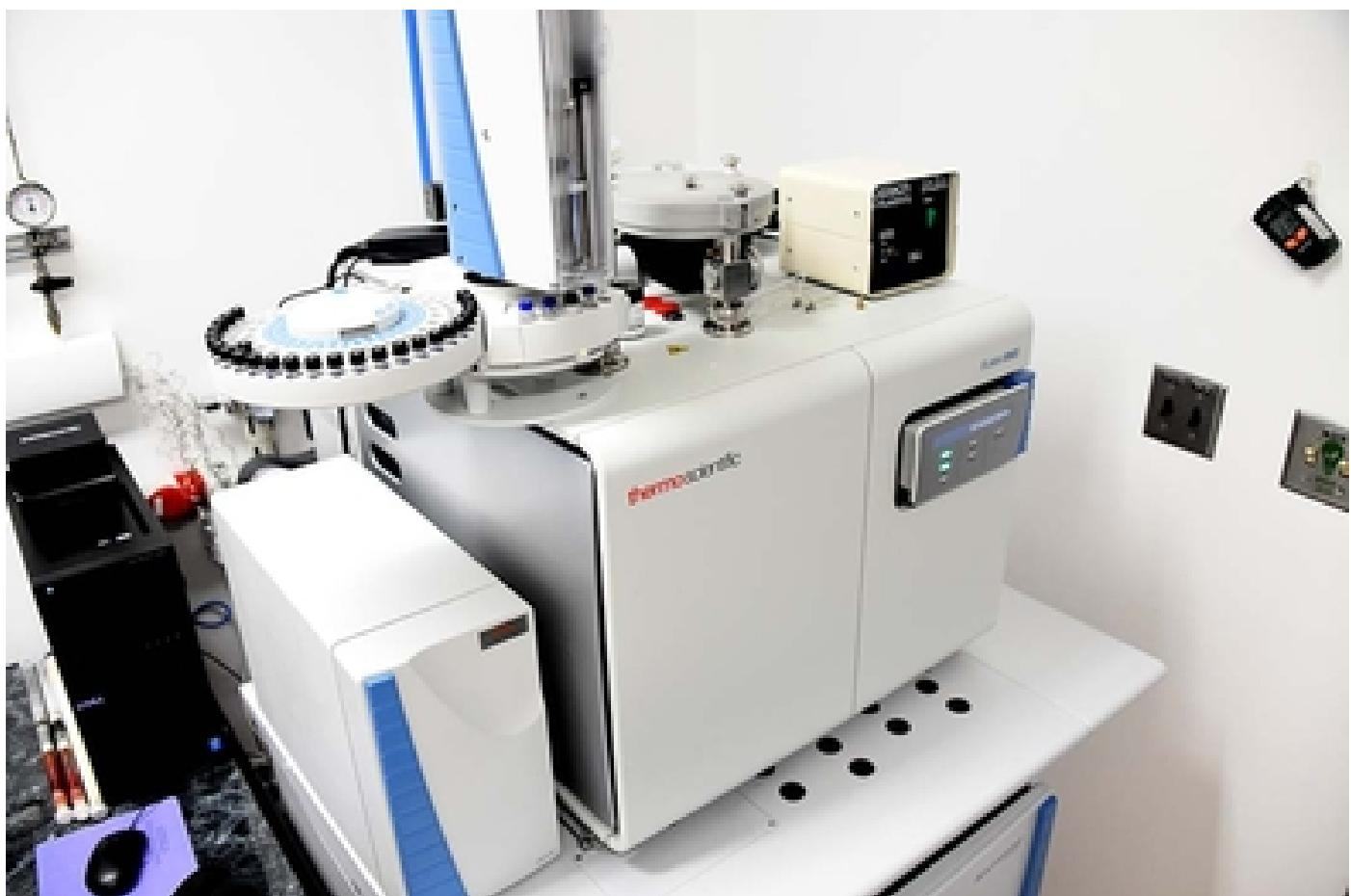
El equipo “Analizador Elemental acoplado a un Espectrómetro de Masas de Relación Isotópica” que se encuentra ubicado en el CICA está a disposición de investigadores e investigadoras de diversas unidades de la UCR como el CIMAR y el CIGEFL, así como para colegas de las universidades estatales y entres gubernamentales que requieran de esta tecnología para el desarrollo de sus investigaciones. Karla Richmond
