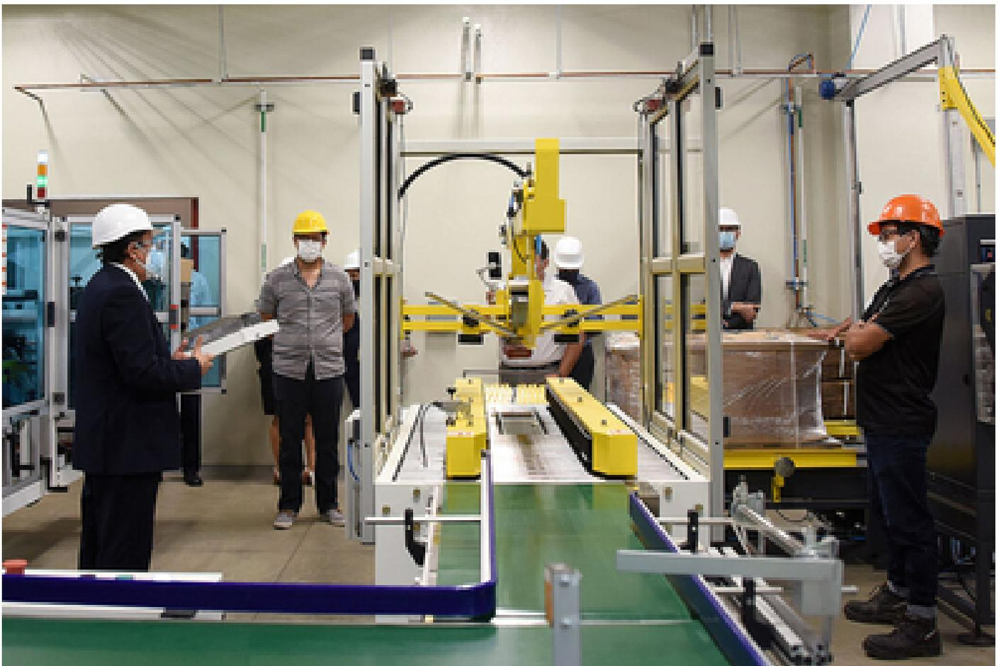
En el Laboratorio de Manufactura y Logística 4.0 se puede recrear un flujo continuo de producción, que inicia con el ensamblaje de cajas, la inyección o termoformado de partes,
