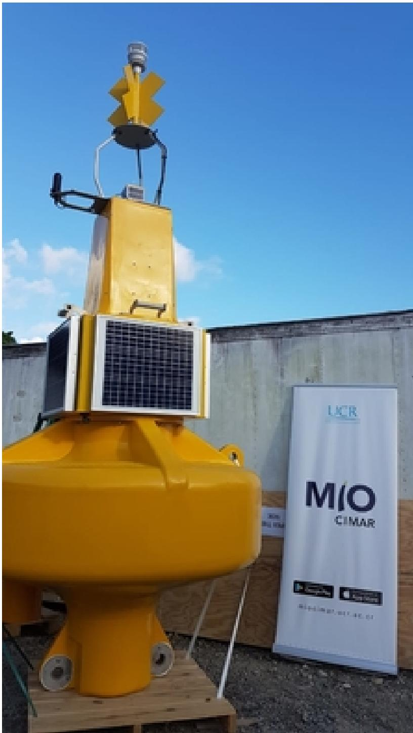
La boy, como se le llama al instrumento, tiene un radio de 3 metros por casi 3 metros de altura. Va sostenido debajo del mar, de manera que no se mueva con el movimiento del agua. Foto: cortesía de Rodney Mora.
