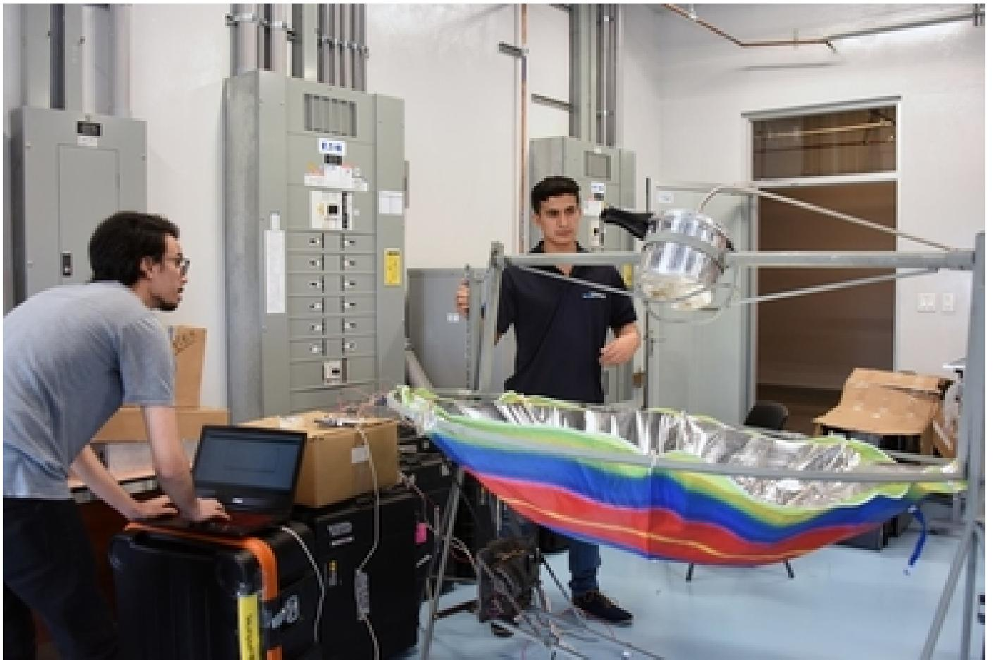
En la imagen se puede apreciar la olla que se ubica sobre la parábola y en la que se vierte el agua salada para que, con el calor que proporcionan los rayos solares y que calientan dicho recipiente, se evapore e inicie el proceso de desalinización (foto Karla Richmond).
