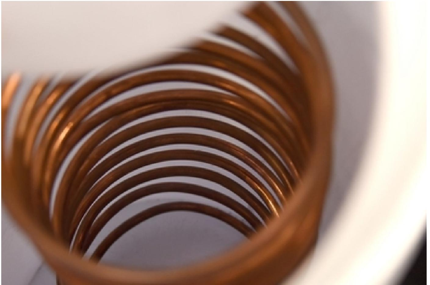
El recipiente final contiene en su interior una bobina de cobre para hacer que el proceso de condensación del agua sea más eficiente (foto Karla Richmond).
