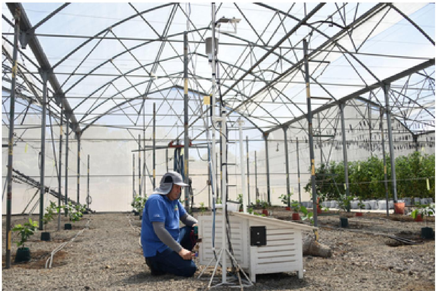
La implementación de estaciones meteorológicas en la Estación Experimental Agrícola Fabio Baudrit permite obtener en tiempo real datos de temperatura, humedad, radiación solar y variables del suelo. Con estos datos, los agrónomos conocen con exactitud las necesidades de los cultivos para hacer un uso eficiente del agua y los nutrientes, al mismo tiempo que se aumenta la productividad. Foto: Laura Rodríguez Rodríguez.
