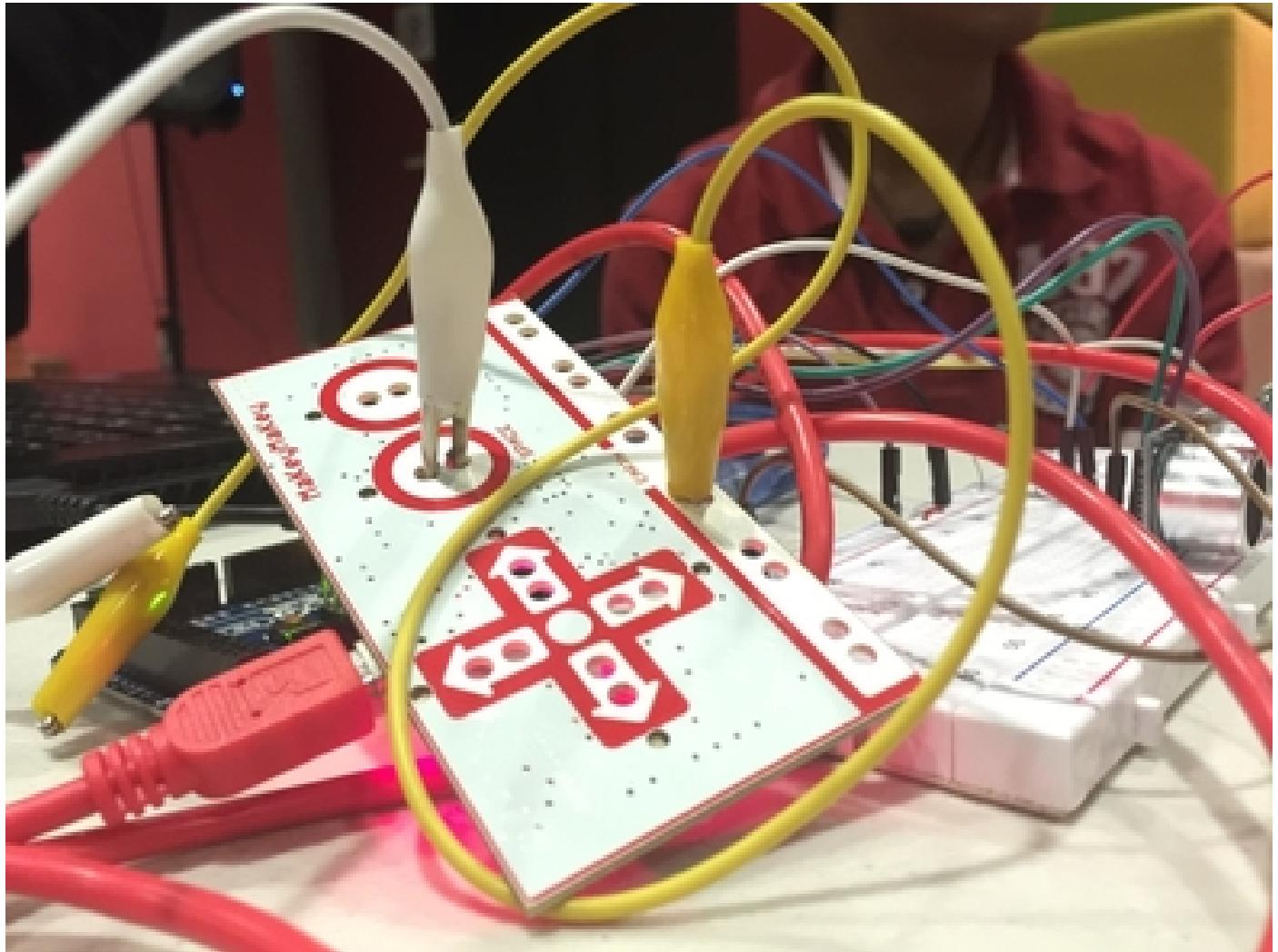
Makey-Makey es una placa con una distribución de botones y con un circuito que se cierra mediante contactos o pinzas de cocodrilo, logrando así el mismo imput que al pulsar un botón, lo cual permite convertir cualquier objeto en un teclado, un mando o un mouse y así enviar órdenes a la computadora.
