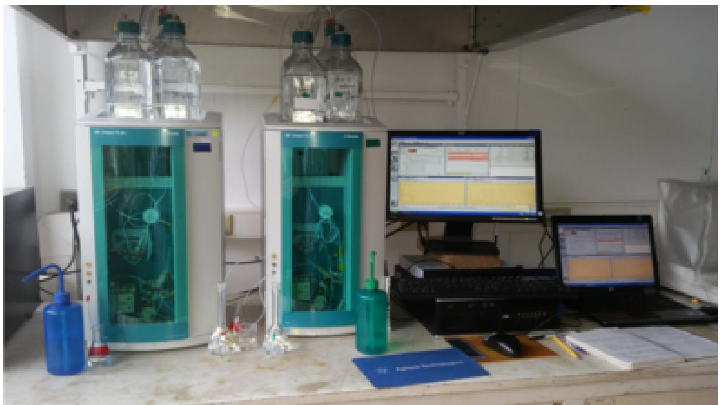
Cromatógrafos de iones del Laboratorio de Geoquímica, de la Escuela Centroamericana de Geología, donde se analizan muestras de ceniza volcánica para determinar la presencia de magma, entre otros aspectos. - foto cortesía RSN.
