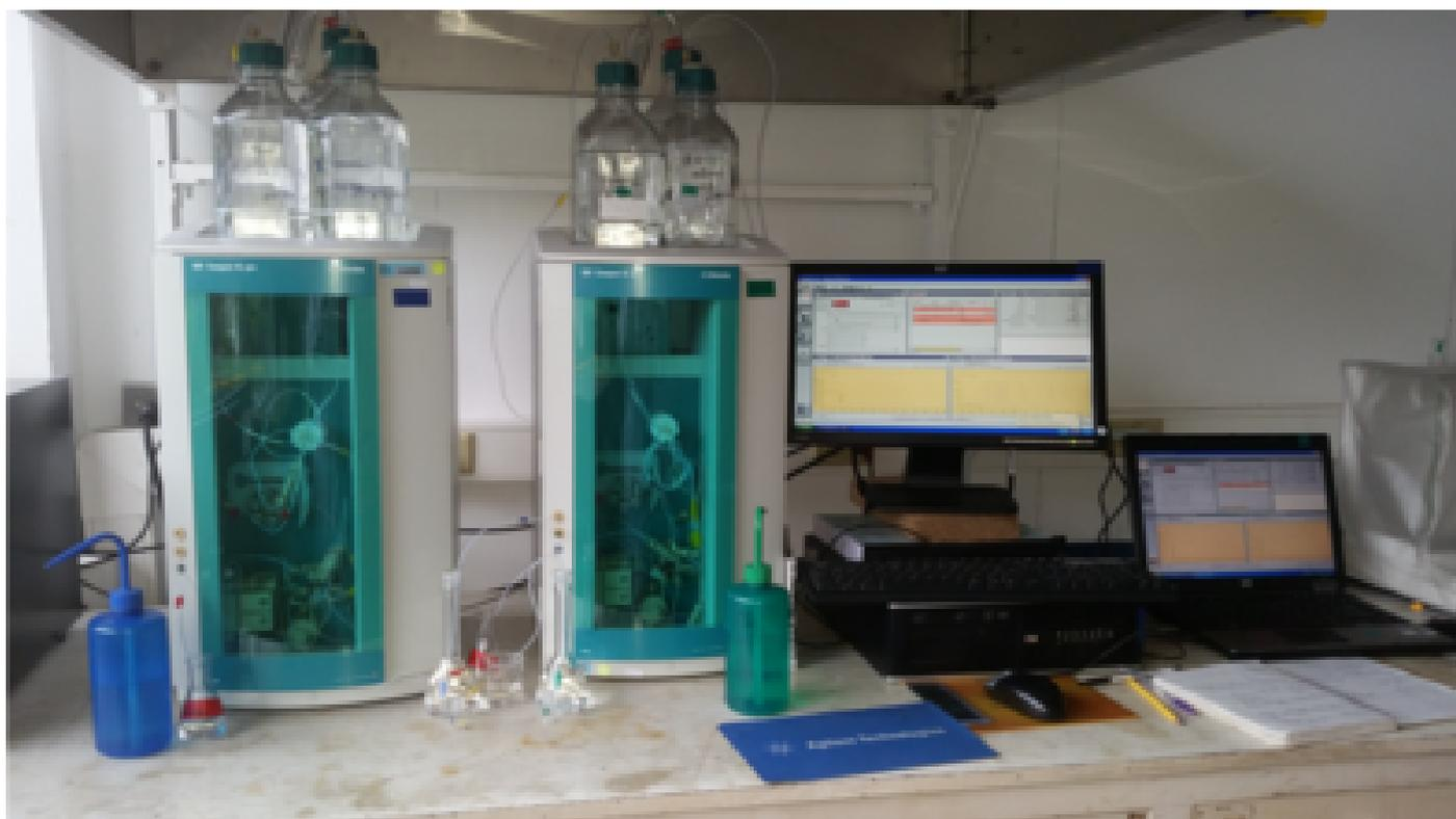
Cromatógrafos de iones del Laboratorio de Geoquímica, de la Escuela Centroamericana de Geología, donde se analizan muestras de ceniza volcánica para determinar la presencia de magma, entre otros aspectos. - foto cortesía RSN.
