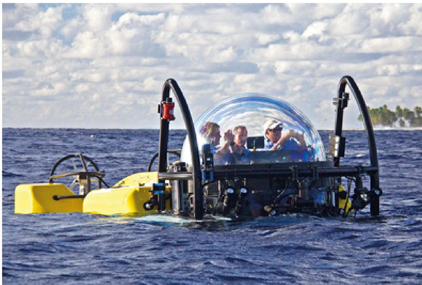
El vidrio del DeepSee tiene el mismo índice de refracción del agua, lo que da la ilusión de que se puede tocar lo que se ve a través de él. En la foto, Federico Morice en una inmersión en Clipperton, isla francesa en el Pacífico - foto cortesía de Federico Morice.
