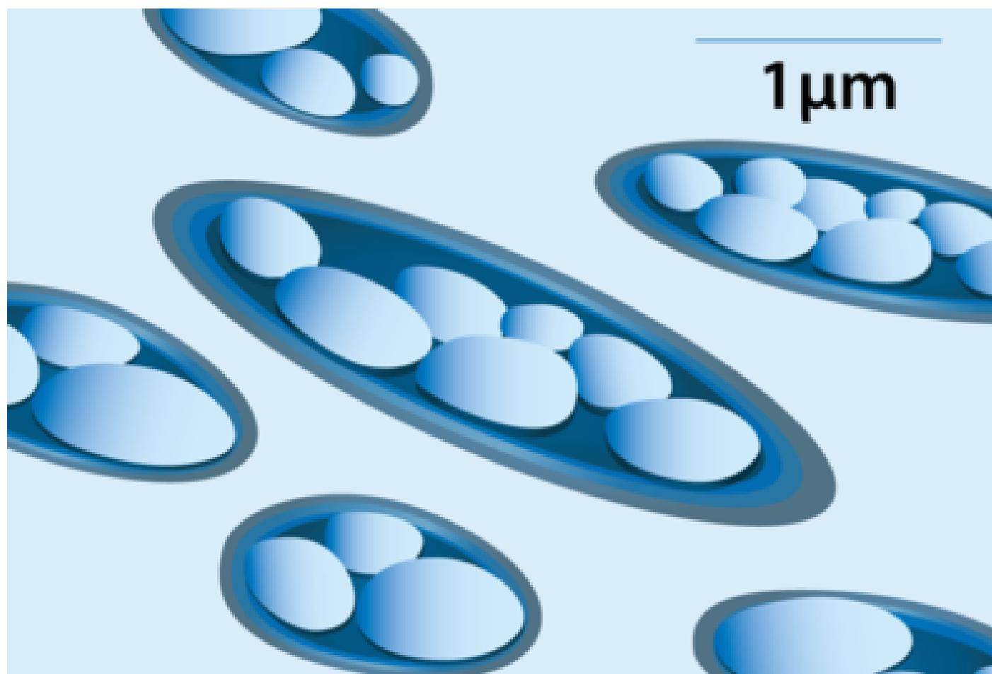
El PHB se almacena en forma de bolitas en el interior de los microorganismos. Para producir plástico con este material se rompen los microorganismos, se separa el PHB que está en su interior y luego se fusiona.
