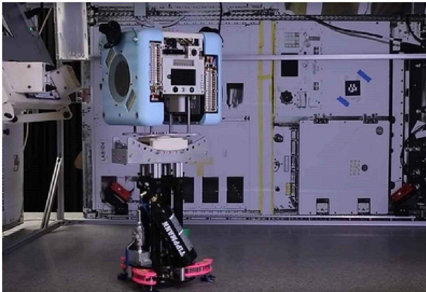
El robot Astrobe forma parte de la nueva generación de robots de asistencia e investigación espacial de la NASA, tiene forma de cubo y mide apenas 30 centímetros por cada lado (foto cortesía de la NASA).
