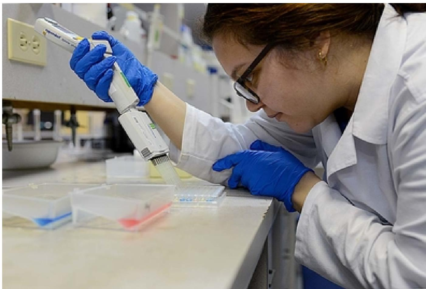
En el Laboratorio de Química del CITA la laboratorista química Silvia Quirós Fallas lleva a cabo el análisis de gluten en muestras de diferentes alimentos. El análisis consiste en la determinación de gliadina a partir de la técnica ELISA, ensayo por inmunoabsorción ligado a enzimas utilizando el anticuerpo gliadina R5. Laura Rodríguez Rodríguez
