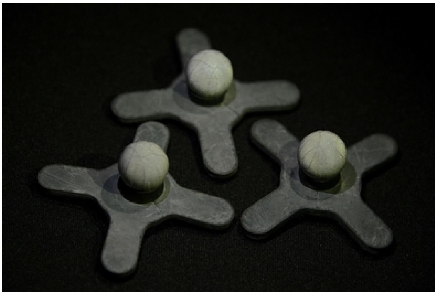
Sin necesidad de baterías, los marcadores pasivos se encargan de reflejar de manera fiel los movimientos; versiones más pequeñas pueden colocarse en los dedos o la cara para asegurar una réplica exacta de todos los detalles (foto cortesía PRIS-Lab UCR).
