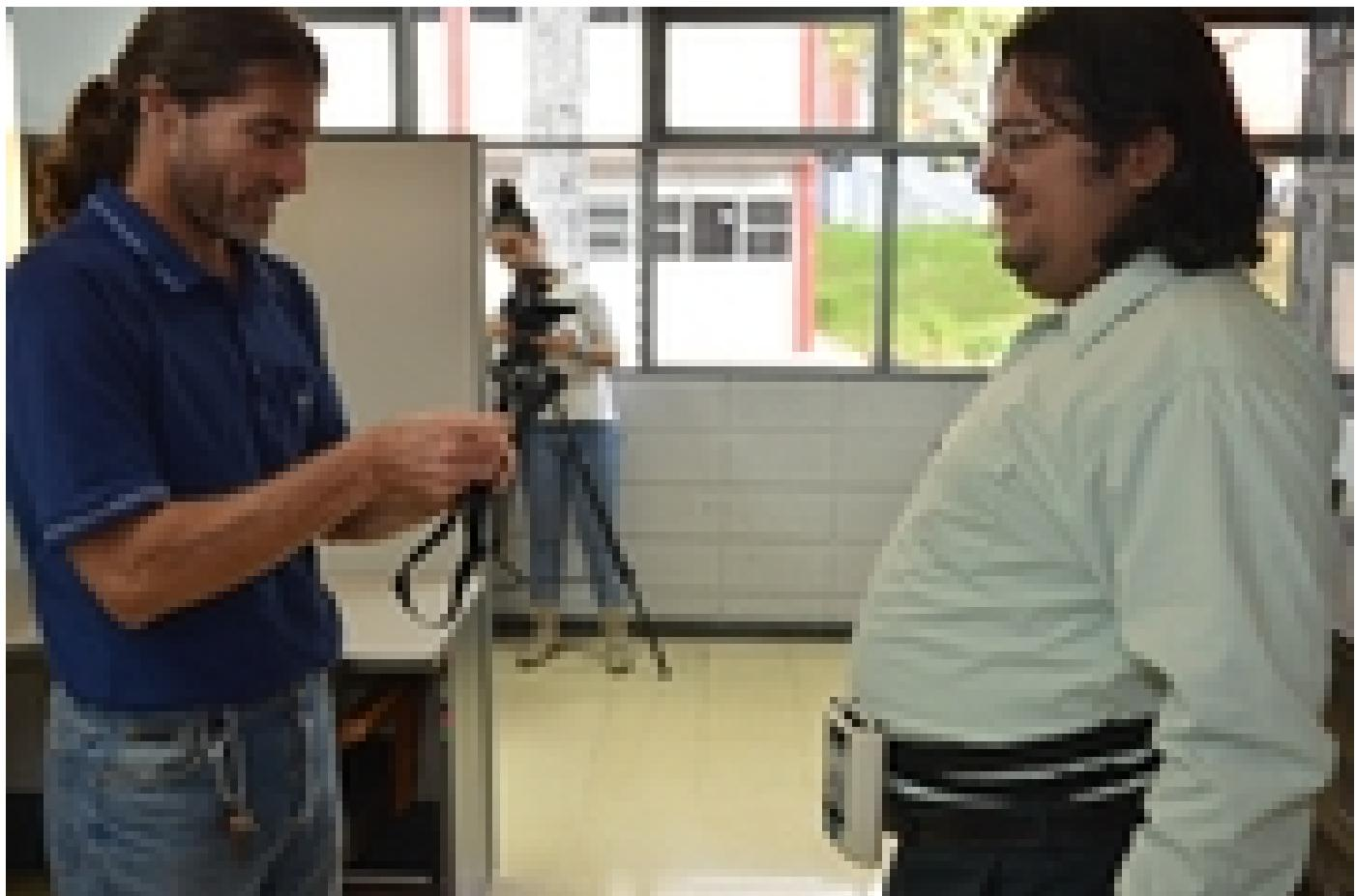
La Unidad de Medida Inercial es un pequeño dispositivo electrónico provisto de acelerómetros, giroscopios y magnetómetros, que se coloca en la cabeza y en la cintura del paciente (foto Manrique Vindas).
