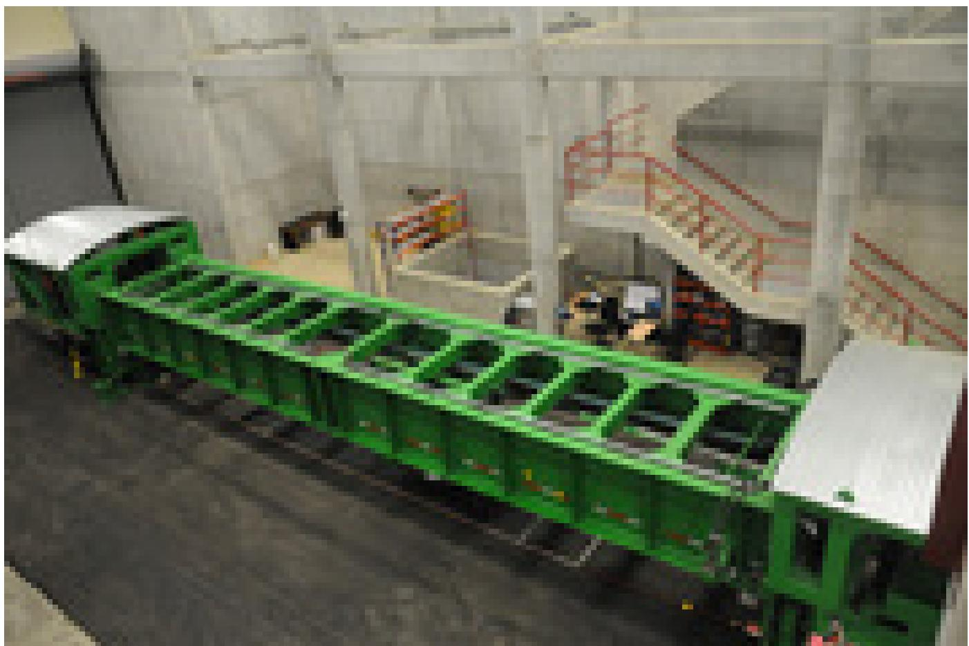
El Simulador de Vehículos Pesados que adquirió el Lanamme es único en América Latina y permite probar la resistencia de los pavimentos (foto Anel Kenjekeeva).
