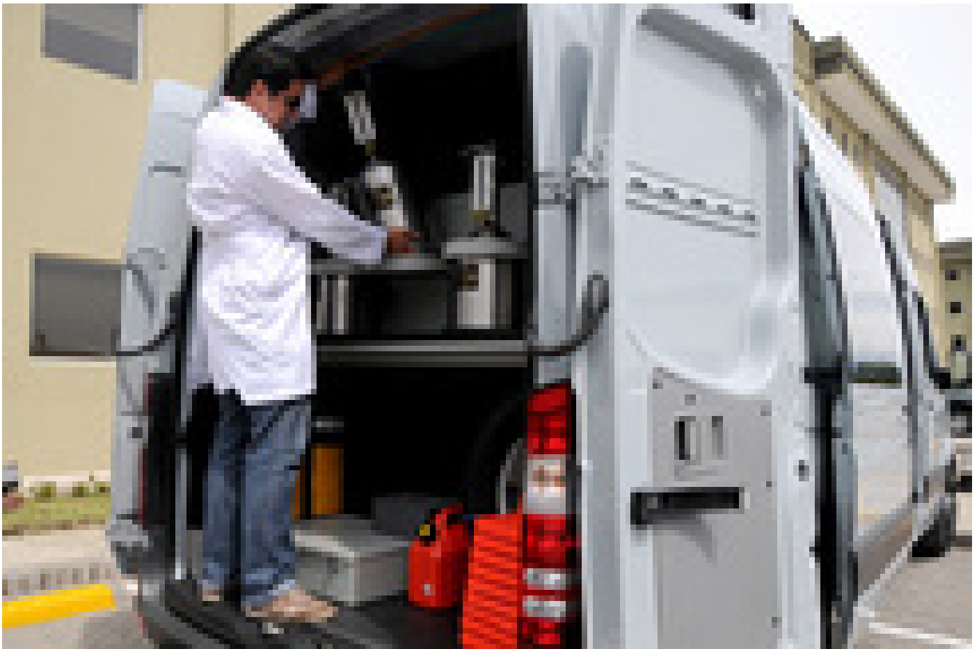
El técnico Romer Marín González muestra los aforadores volumétricos ubicados en la parte trasera del vehículo. Laura Rodríguez
