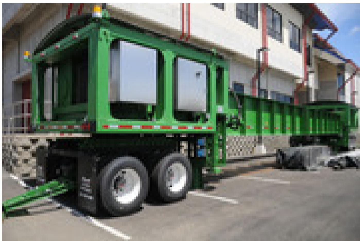
El Lanamme cuenta con un Simulador Pesado de Vehículos con el cual se puede determinar la resistencia de la superficie de rodamiento de los puentes (foto Anel Kenjekeeva).
