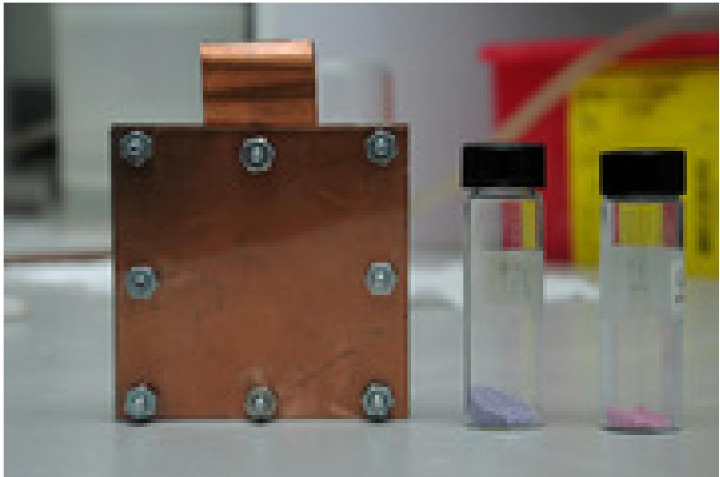
En la celda prototipo eleborada con cobre y otros materiales se lleva a cabo la electrólisis de agua para producir hidrógeno. En los tubos se muestra el fosfato de cobalto puro y dopado con calcio (foto Laura Rodríguez).
