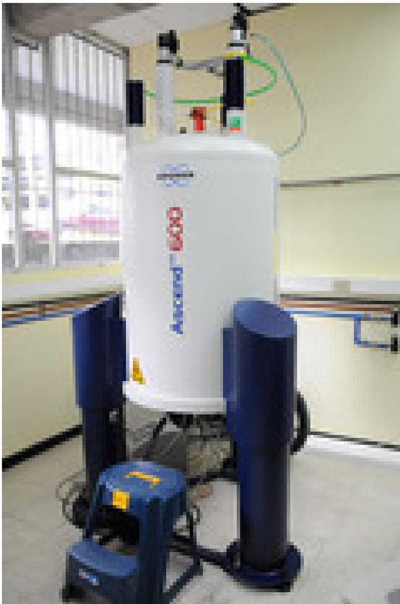
Este es el 600 MHz Ascend, para su instalación y puesta en servicio fue necesario la coordinación con las secciones de mantenimiento eléctrico, de compras, de bodega y con el Lanamme ya que se trata de un equipo que requiere condiciones especiales y un entorno físico adecuado (foto Cristian Araya).
