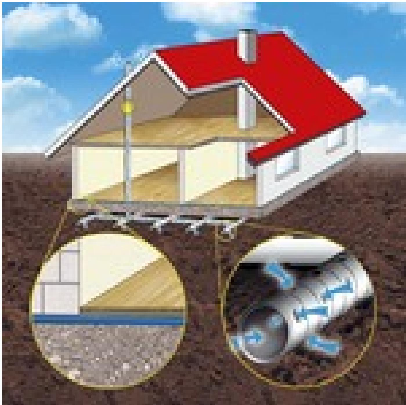
Para disminuir el radón en edificios se puede utilizar un sistema de ventiladores, entre otras medidas ( imagen tomada de: [www.bfs.de/en/ion/radon/radondrainage](http://www.bfs.de/en/ion/radon/radondrainage)).
