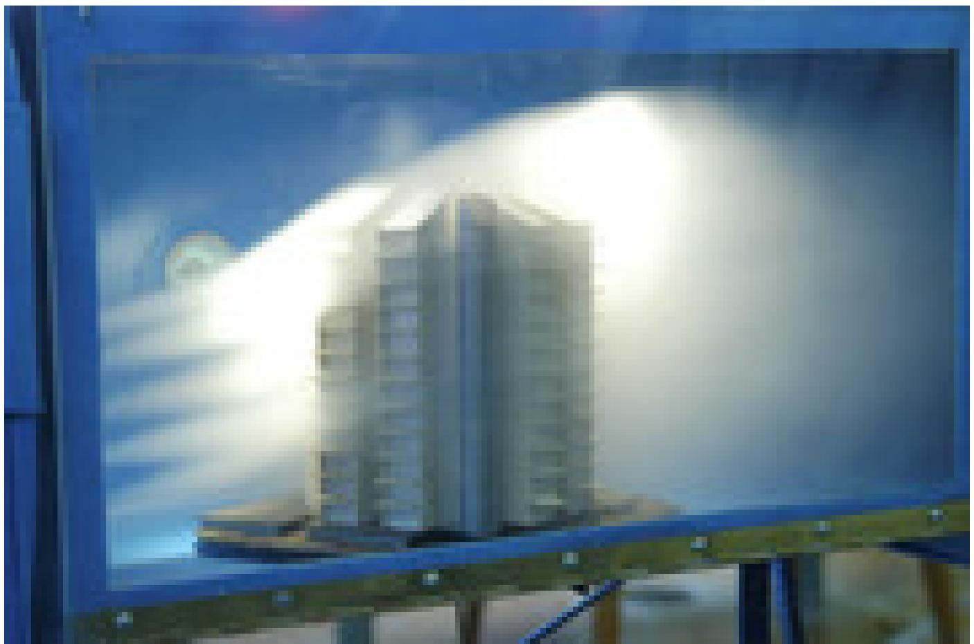
En la demostración del túnel se observa como esta maqueta es azotada por una corriente a la que se le aplicó humo para poder obsevar la acción del viento.
