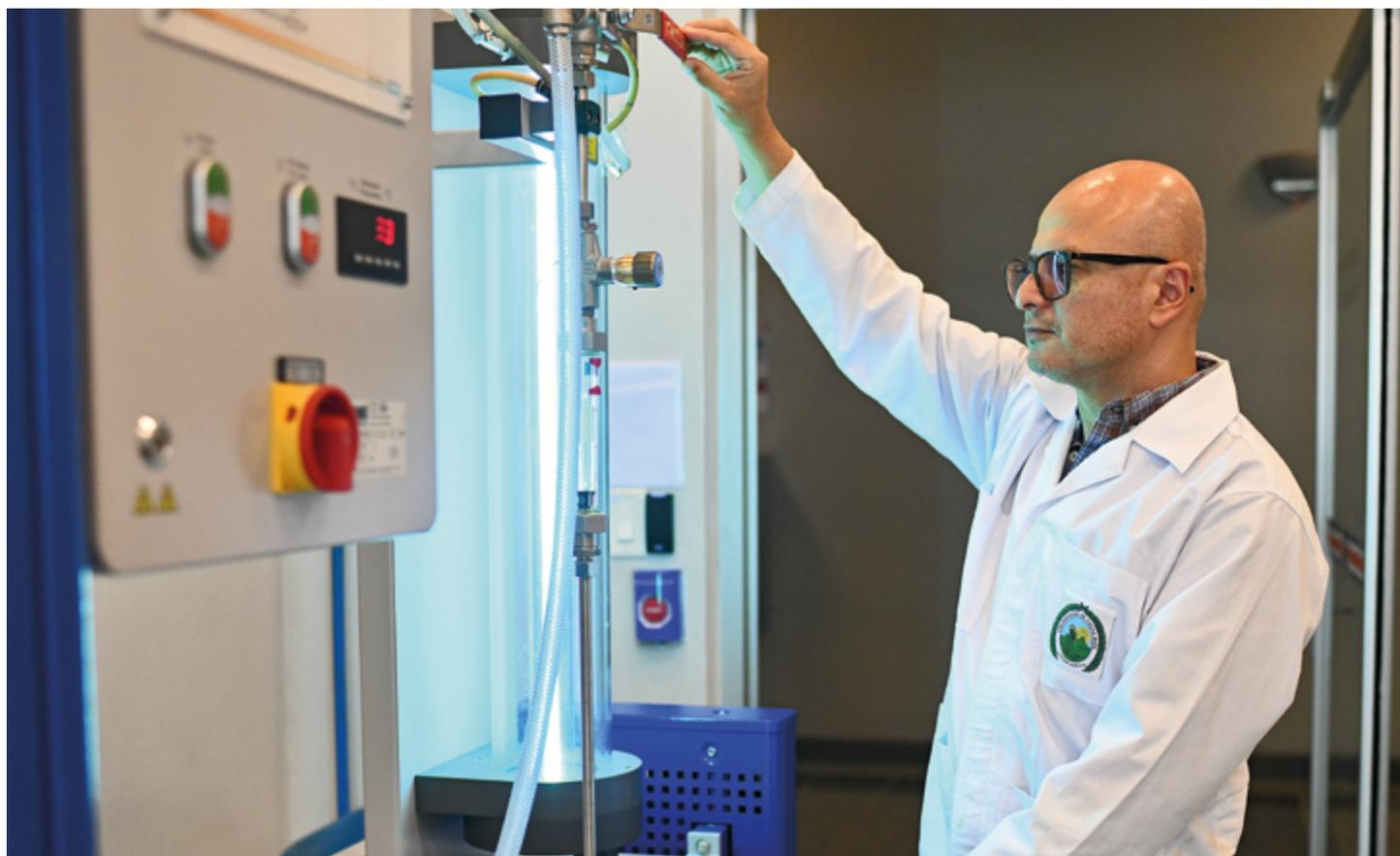
Los investigadores utilizan un reactor ultravioleta de película descendente, que sirve para probar el tratamiento de agua mediante procesos de oxidación avanzada a escala de laboratorio. Foto: Laura Rodríguez.
