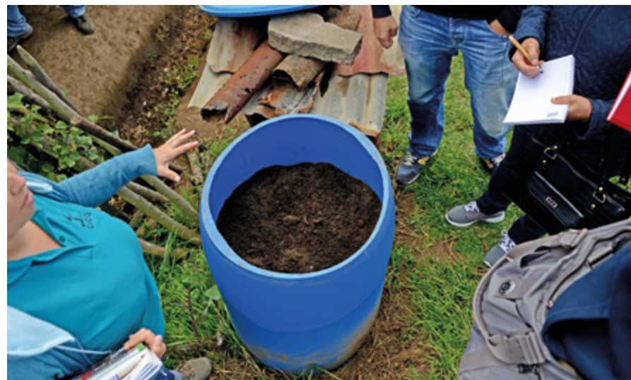
Los biobeds son un método simple y de bajo costo para la degradación de plaguicidas en pequeñas fincas (foto Laura Rodríguez).
